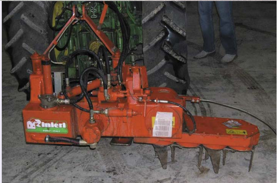
Utilització de braç mecànic desplaçable pel control d'herbes en el rengle de fruiters
